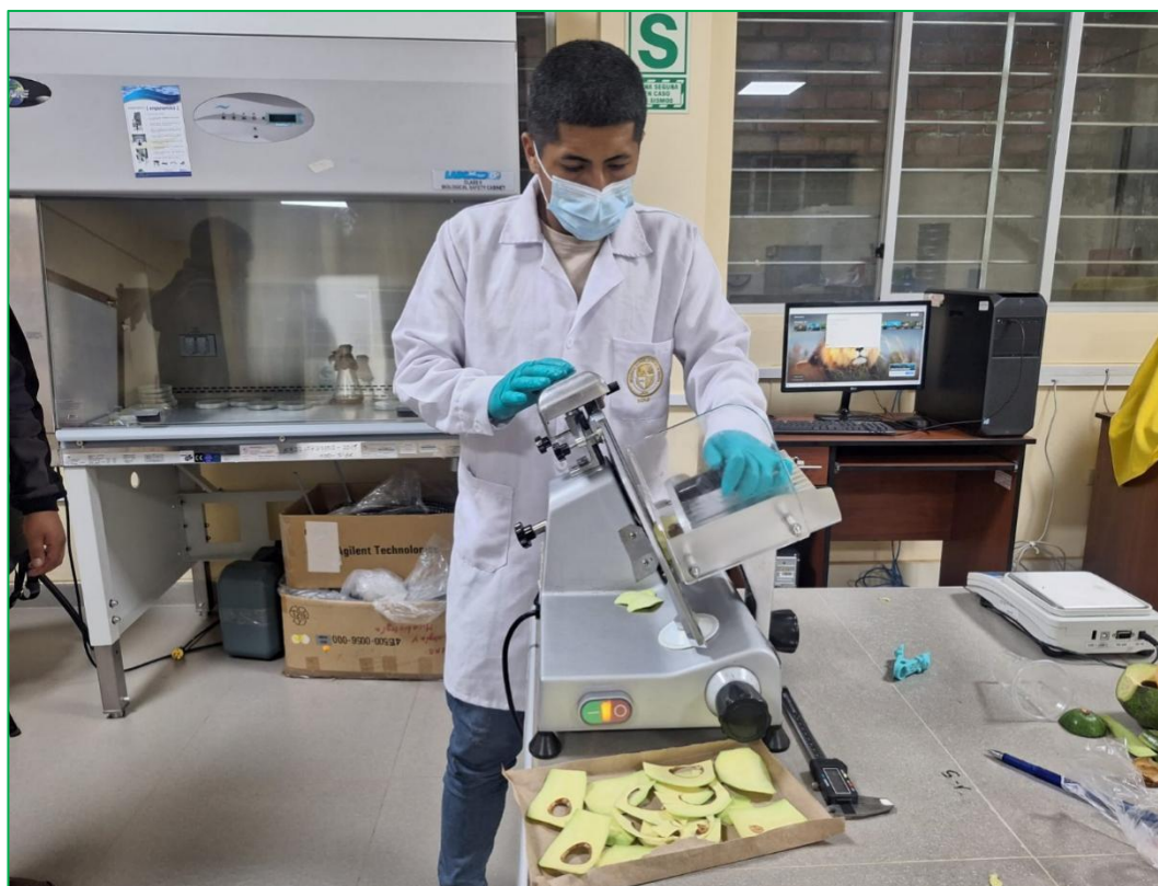
Fotografía 8: Preparación de muestras en la máquina laminadora
