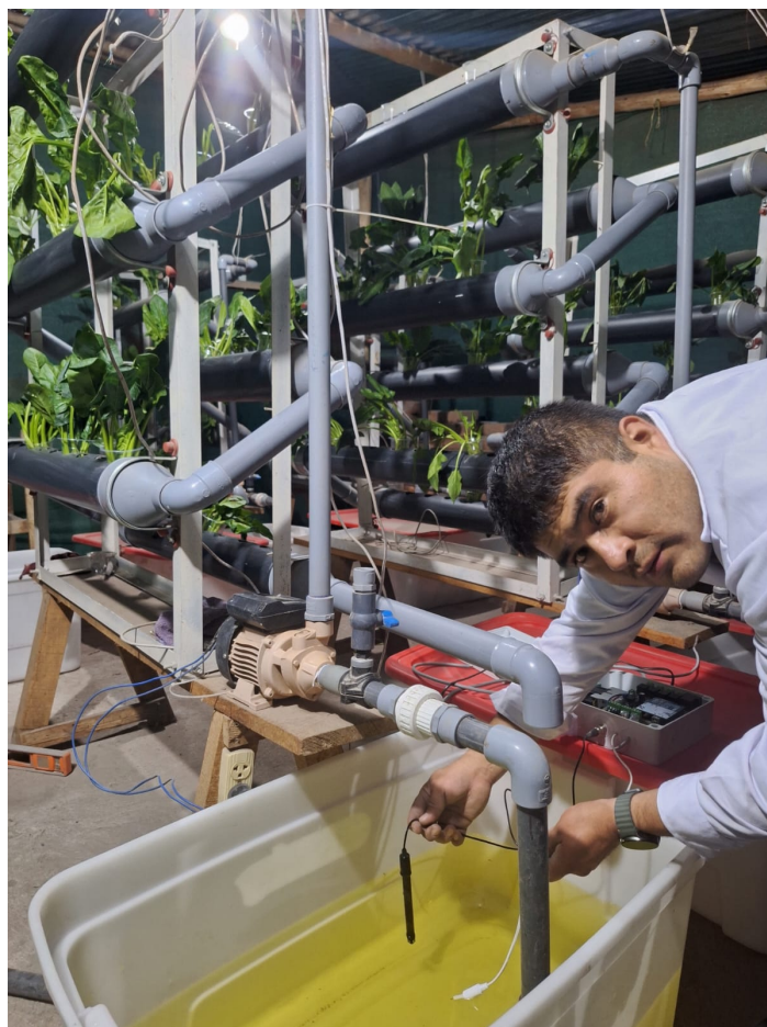
Figura C.10. Monitoreo de la solución nutritiva en el reservorio del sistema NFT.
