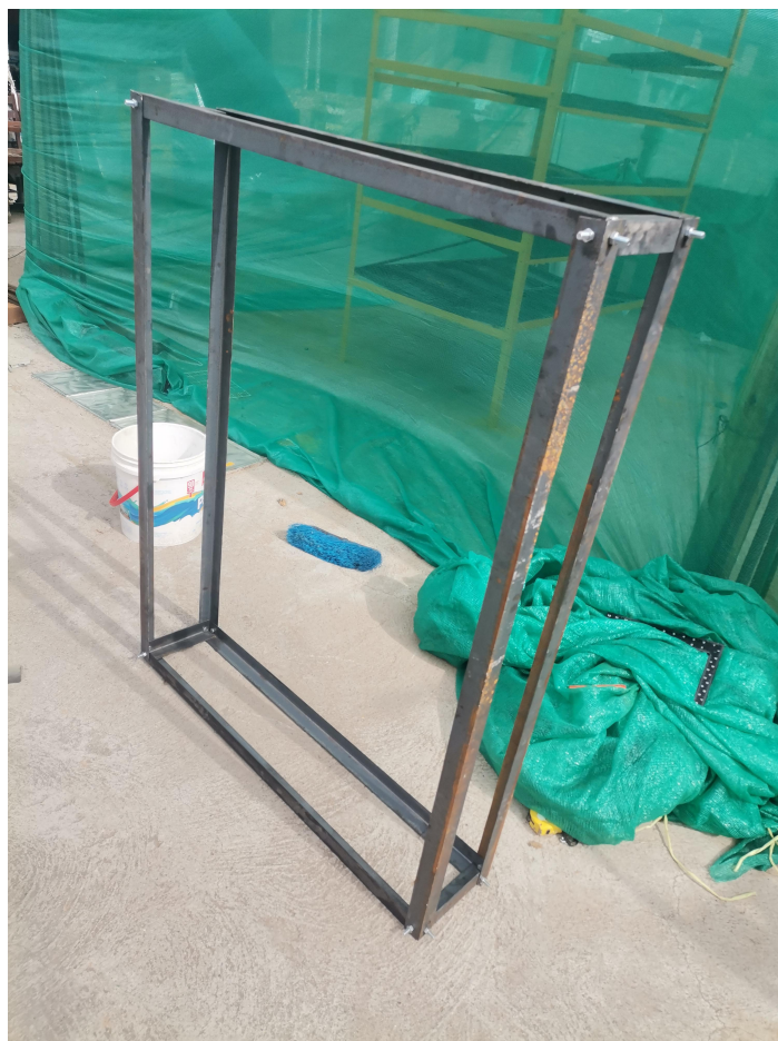
Figura C.5. Estructura metálica utilizada como soporte de los canales hidropónicos NFT.
