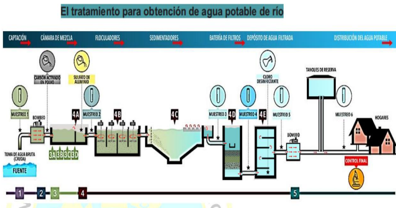
Figura 1. Proceso de potabilización del agua
