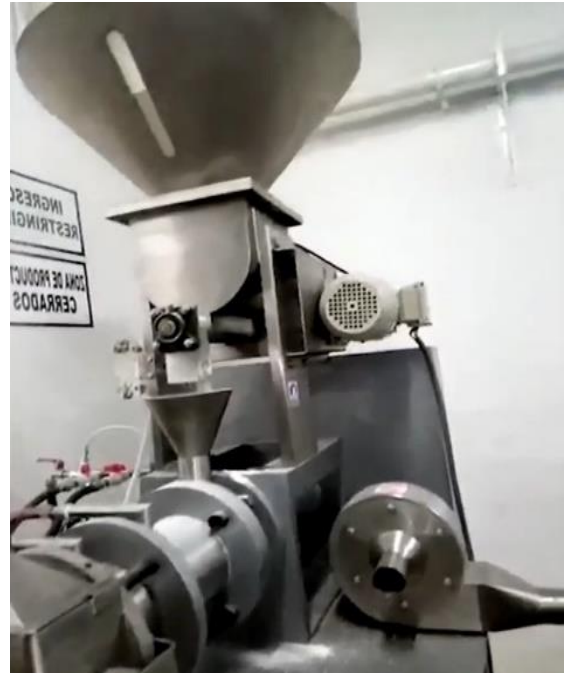
Foto 2: Acondicionamiento de la tolva de la maquina extrusora
