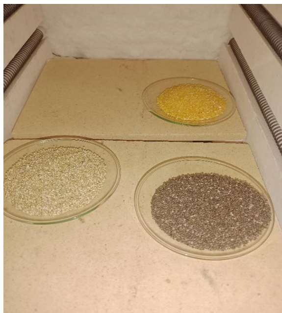
Foto 8: cálculo de la humedad de la materia prima
