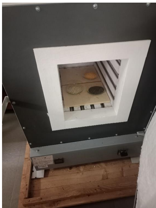
Foto 27: Puesta de la muestra en mufla
