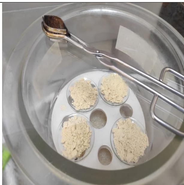
Foto 26: Determinación de la humedad y puesta en campana por 4 horas
